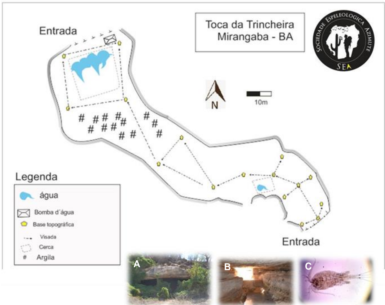
Figura 2. Mapa Topográfico da Toca da Trincheira. A. Entrada; B. Poça onde aflora o lençol freático; C. Copepoda Cyclopodidae encontrado na água da caverna.
