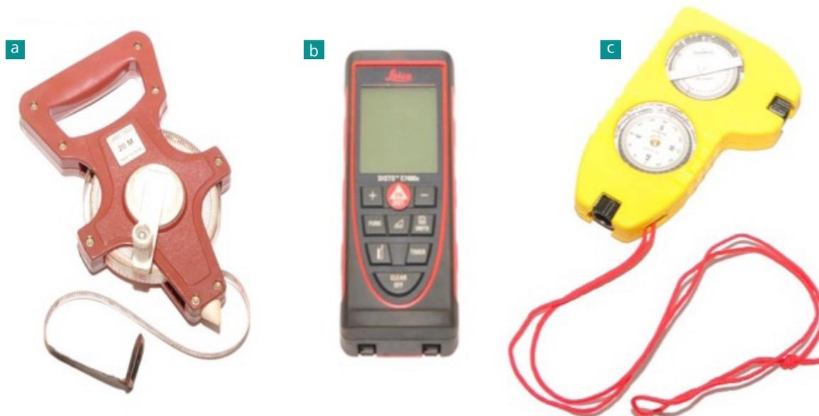
Figura 2.22. Equipamentos utilizados em levantamentos espeleotopográfico: (a) Trena de PVC; (b) Trena a laser; (c) Bússola e clinômetro de visada. Fotos: Allan Calux.
