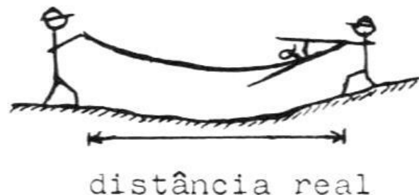
Fig. 1 - Superestimação da medida realizada devido à curvatura da trena. O ângulo \alpha de inclinação também está superestimado.
