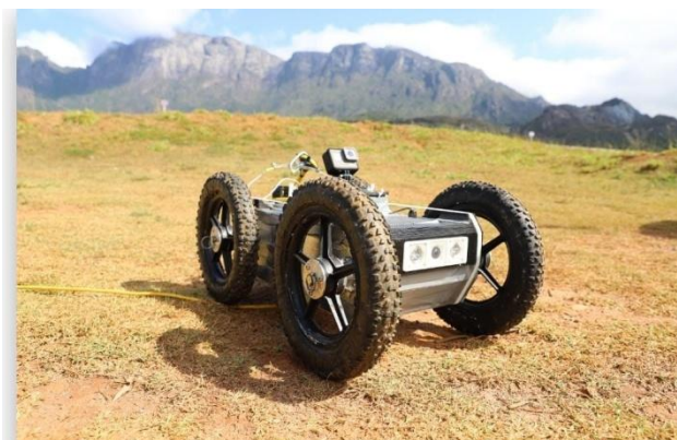
Figura 1: EspeleoRobô. Equipamento desenvolvido pela gerência de espeleologia com o ITV.
