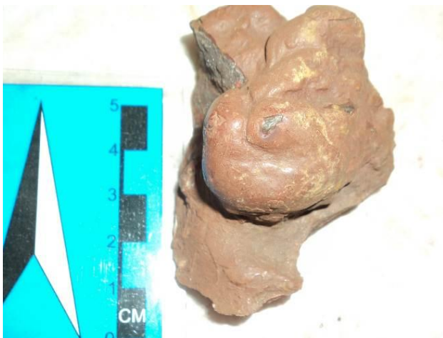
Foto 11: Camada externa da crosta ferruginosa na cavidade CV05.
