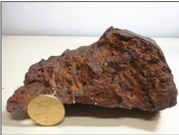
Figura 9: Amostra de rocha do teto da caverna S11D-0055, coletada na interface canga/minério. A rocha é formada por canga e apresenta cavidades de dissolução.
