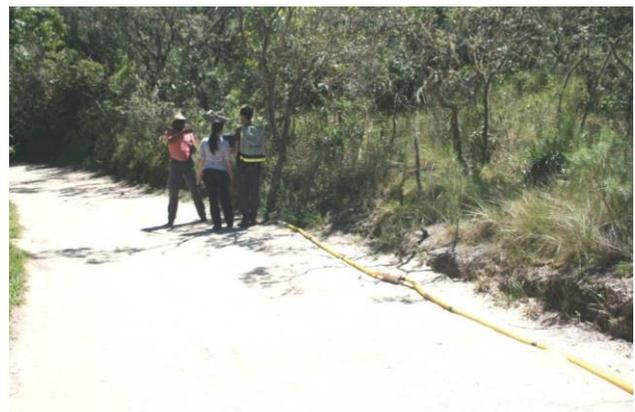
**Figura 7:** Investigação geofísica utilizando o método do Radar de Penetração no Solo no PEI.
