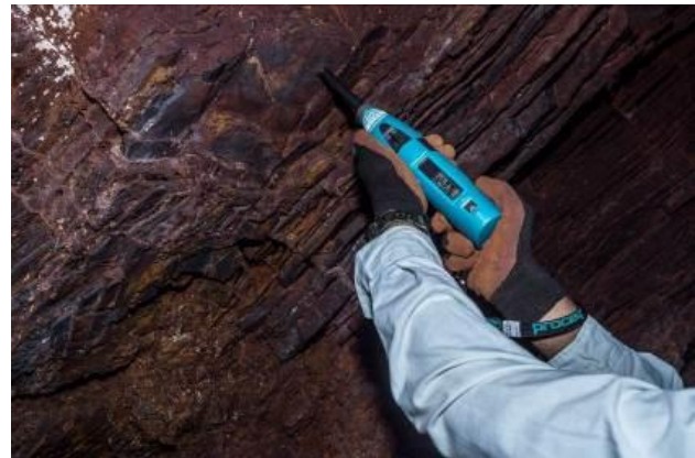
Figura 2: Exemplo de aplicação do martelo de Schmidt.
