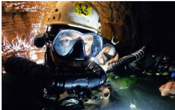
Mergulhadores usando sistema de circuito fechado.
