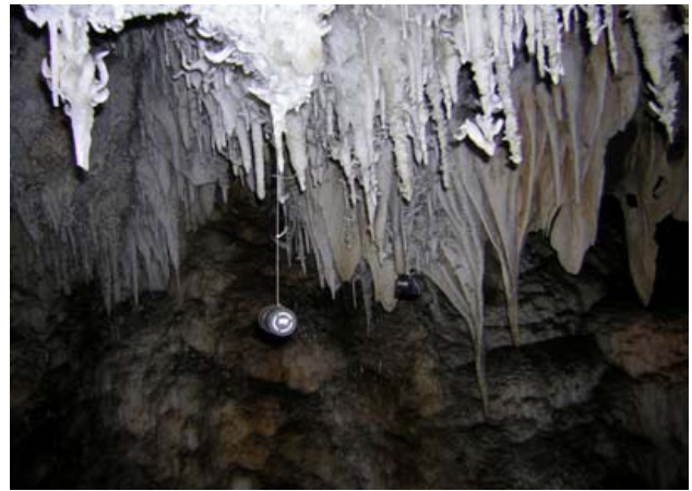
Figura 2 – Monitor KFK pendurado em estalactite em caverna do PETAR.
