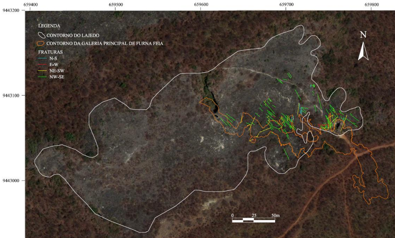
Figura 4 - imagem do lajedado de Furna Feia mostrando as fraturas mapeadas com GPS geodésico e projeção da galeria principal da Furna Feia. (Fonte: Digital Globe/2009).
