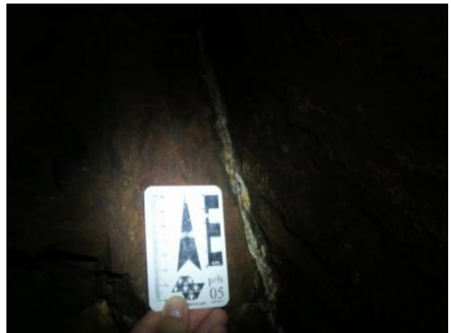
Foto 4 – Fino veio de calcário preenchendo fraturas no diabásio. Foto: Nair Fernanda Mochiutti.
