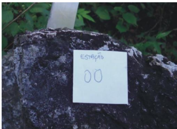
Figura 2 – Modelo de estação marcada para indicação da irradiação no mapeamento (FONTE: CARDOSO, C. L. 2012).
