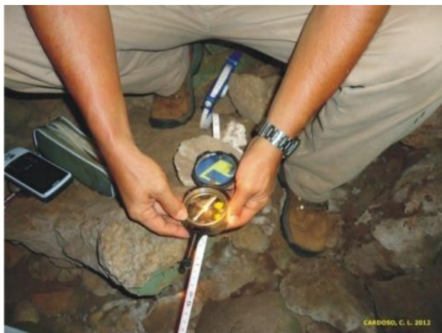
Figura 3 – Realizando medição entre os pontos e direcionando posição através da bússola (FONTE: CARDOSO, C. L. 2012).
