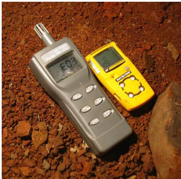
**Figura 2** – Medidor portátil de CO<sub>2</sub> e detector multigases no salão de entrada da Lapa do Sufoco, durante o levantamento das condições de qualidade do ar da caverna.
