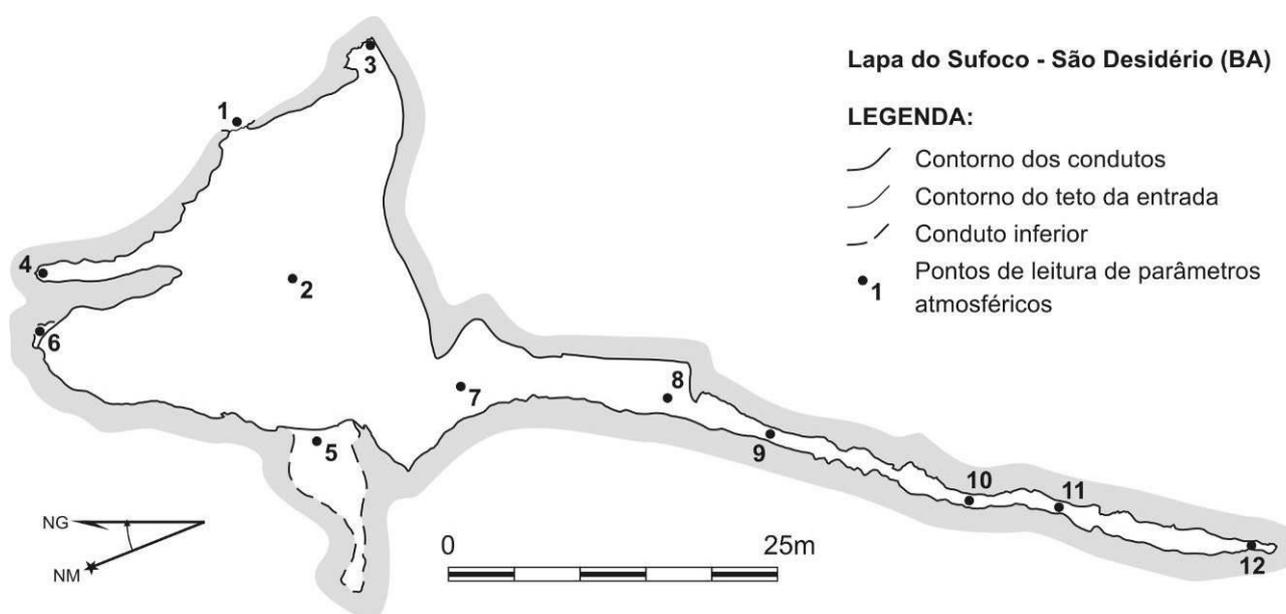
**Figura 6** – Planta baixa com os contornos dos condutos da Lapa do Sufoco (precisão BCRA 3C), indicando os pontos de leitura de parâmetros atmosféricos ao longo da cavidade. Detalhes de ornamentações e preenchimento da caverna foram omitidos, em favor de clareza.
