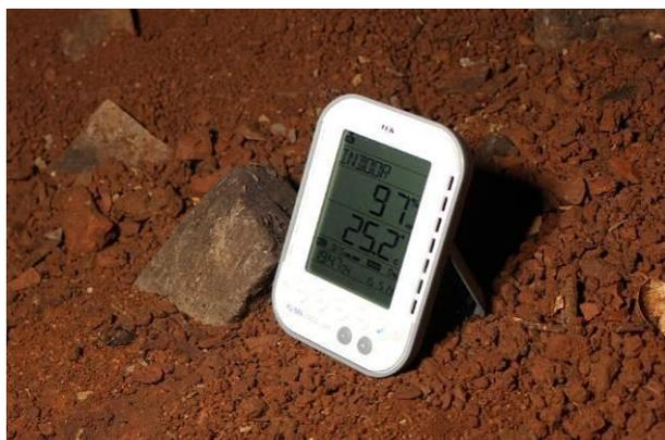
**Figura 3** – Termo-higrômetro posicionado no piso do salão de entrada da Lapa do Sufoco.
