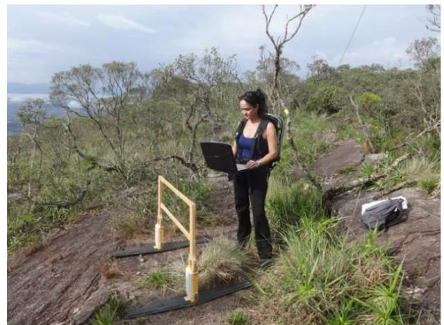
**Figura 2.** Equipamento GPR utilizado na investigação geofísica.
