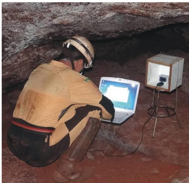
**Figura 1:** Coleta de dados de temperatura e umidade relativa do ar realizada no interior da cavidade N4WS-067.
