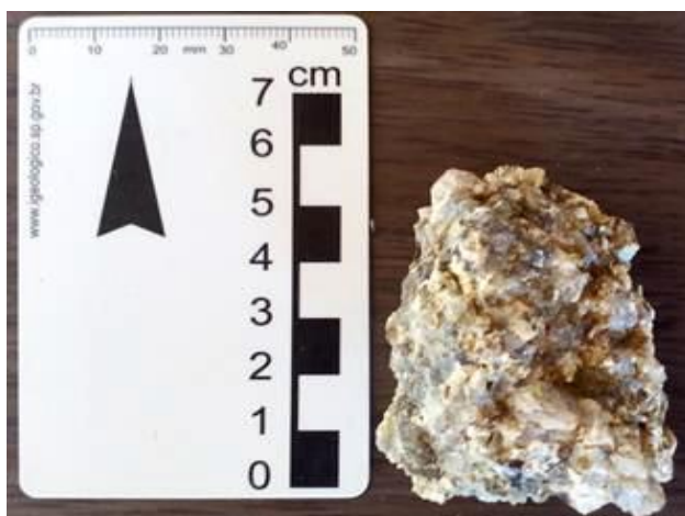
Figura 02: Amostra do Granito Ilha com granulação média a grossa com sua peculiar cor rosada devido à oxidação do ferro da biotita (Foto: M. Moreira, 2016).
