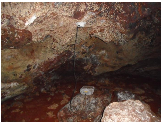
Figura 4: Geofone fixado no teto da cavidade com uso de gesso.
