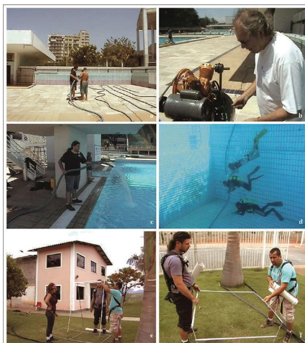
Figura 1: Sequência de fases de simulações controladas: (a – d) testes em piscina para aferir o sucesso do sistema de aspiração subaquática em condições de baixa profundidade e mangote longo, cobrindo distâncias superiores a 200 m na superfície; e (e – f) simulações de montagem do grid e do quadrupé sub para fotografia.
