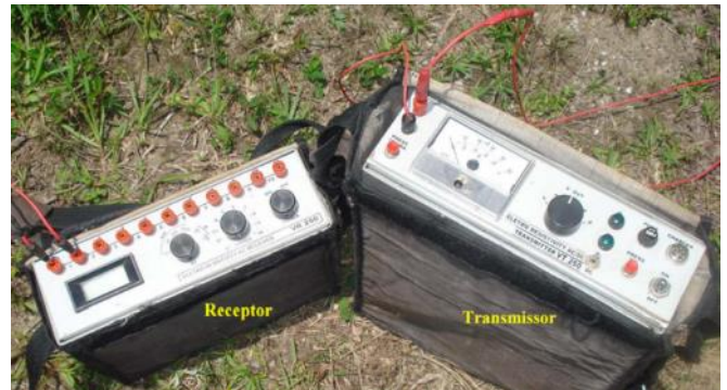
Eletrorresistivímetro (transmissor-receptor) usado no estudo
