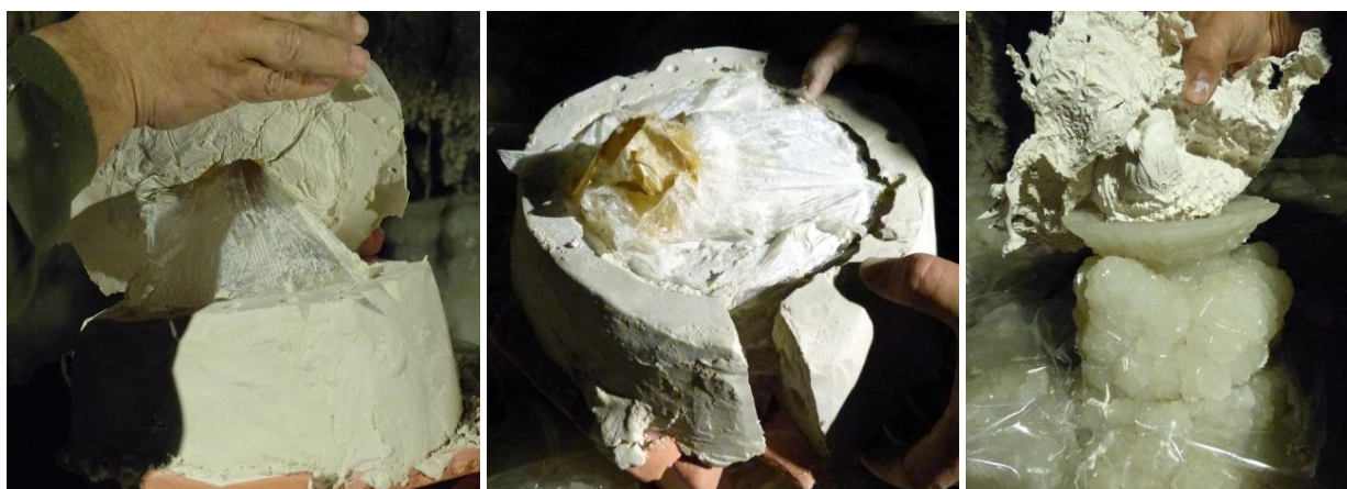
Figura 8. Extracción de las piezas de la carcasa y del molde de silicone.
