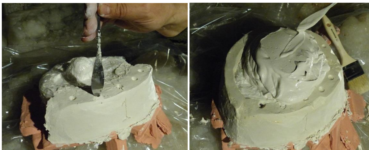
Figura 7. Fabricación de las cuatro piezas de la carcasa de escayola y sus llaves correspondientes.
