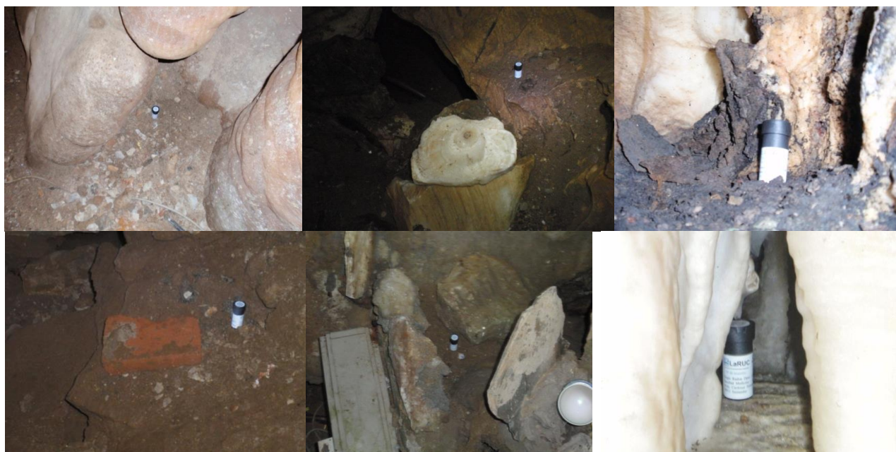
Figura 1.- Fotografías de algunos de los detectores pasivos de Radón instalado en la Gruta de las Maravillas, facilitados por la Universidad de Cantabria.
