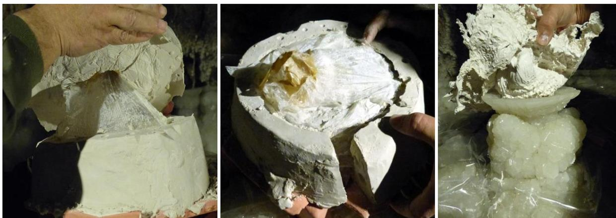
**Figura 8.** Extracción de las piezas de la carcasa y del molde de silicona.
