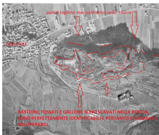
Fig. 3b - In rosso sono state tracciate le principali evidenze che emergono dalla sola foto aerea della fortificazione "tagliata" nella viva roccia.
