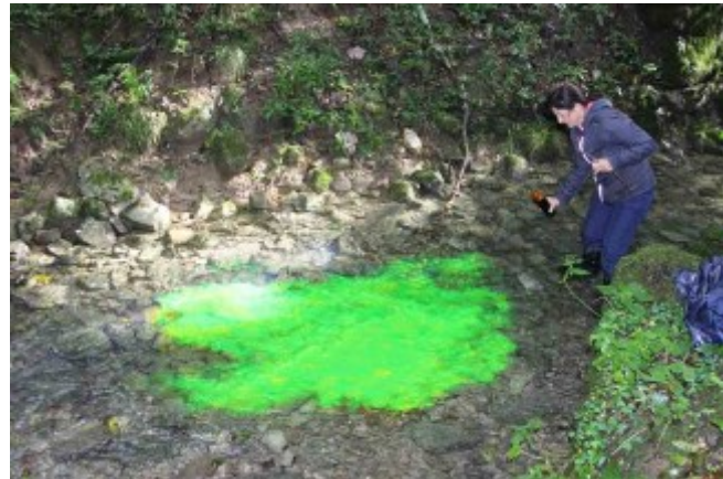
Corso di Idrologia carsica 2017 - Tecniche di tracciamento - Stage sperimentale. Immissione di Fluoresceina nelle acque del Rio Lieskovaz.
