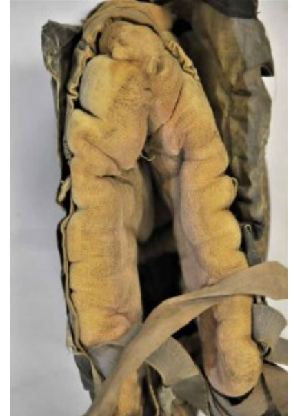
Fig. 6.24b - Dettaglio dell'interno della così detta "maschera antigas" italiana: vi è in tampone di garza e non già un filtro propriamente detto, come nelle maschere antigas inglesi, francesi, tedesche e americane.
