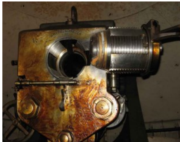
Fig. 6.66 - Particolare della culatta con i freni idraulici e il vitone dell'otturatore di uno dei quattro pezzi d'artiglieria da 149/35 S di cui era dotato il Forte Montecchio Nord, noto come Forte Lusardi. Si tratta dell'unica batteria corazzata italiana integra che ha "partecipato" alla Prima Guerra Mondiale e senza sparare un solo colpo in quanto situata in retrovia; successivamente è stata utilizzata dal Regio Esercito come polveriera.
