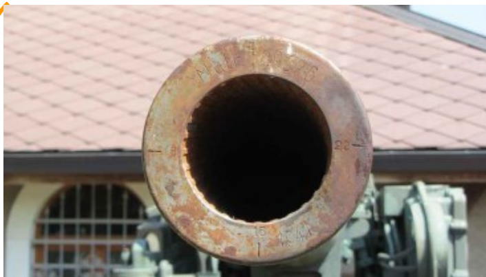
Fig. 6.18 - Bocca di un cannone utilizzato durante la Seconda Guerra Mondiale: si noti la rigatura interna.
