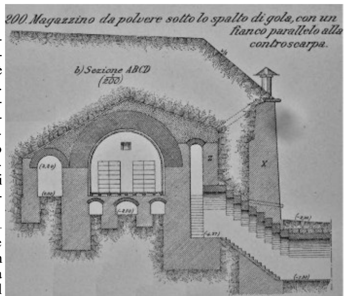
Fig. 6.132 - Polveriera del XIX secolo ricavata all'interno di un bastione.
