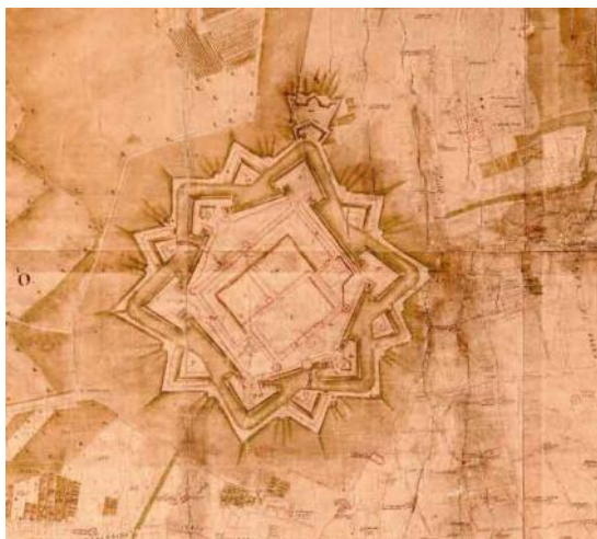
Fig. 1 - Catasto di Carlo VI (“Teresiano”): Mappa di Filippini datata 1722, raffigurante la Fortezza Reale con sei baluardi e sei rivellini che racchiude il Castello di Milano.
