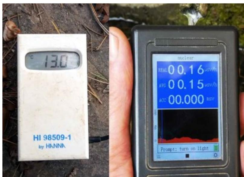
**Fig. 5 - Misure di temperature dell'acqua (13,0° C) e della radioattività presso il tubo da cui esce l'acqua (0,15 µSv/h).**
