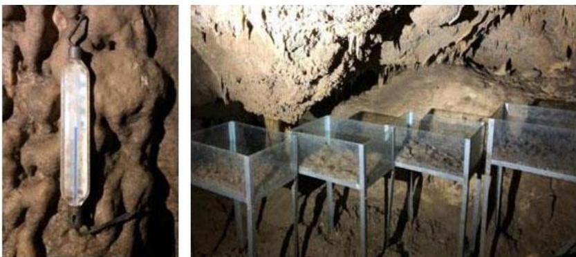
**Un termometro fissato sulla parete e alcuni terrari installati lungo la galleria principale. A lato si vede la scala posizionata nel bel pozzo di accesso all'interno della grotta.**
