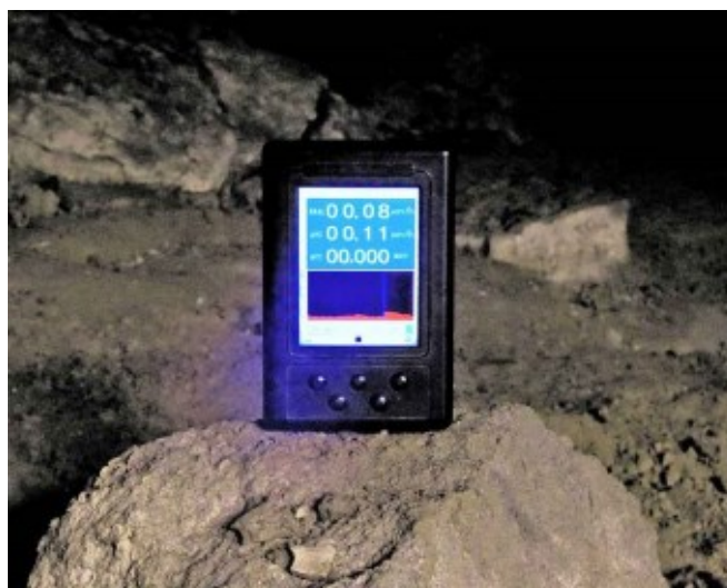
Fig. 3 - Misura della radioattività entro una cavernetta nel Flysch dietro la chiesa di Piedimonte (CAL04- Gorizia). Il valore medio di 0,11 \mu\text{Sv/h} è nella norma.
