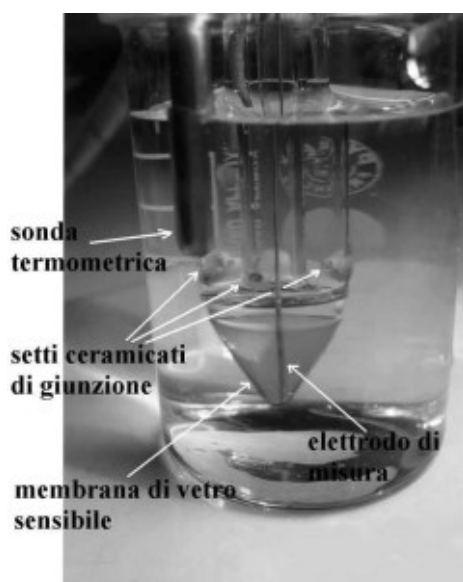
Fig. 4 - Sonda di precisione utilizzabile per acque piovane. Dotata di 3 giunzioni in ceramica che garantiscono una emissione nella soluzione acquosa di circa 50 micro-litri di 3M KCL (foto E. Merlak).
