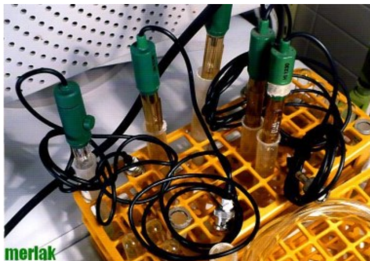
Fig. 3 - Serie di elettrodi calibrati pronti per la misura di più campioni d'acqua piovana prelevati nella stessa stazione di rilevamento (foto E. Merlak).
