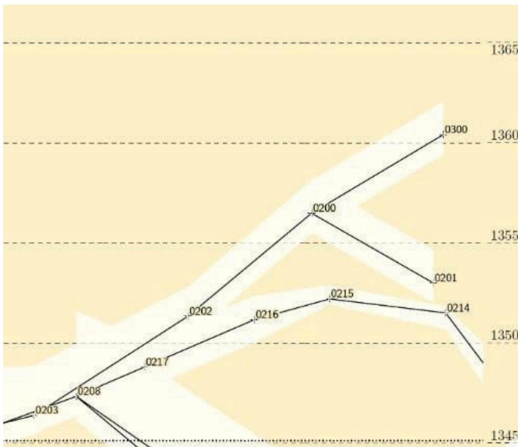
**Figura 21:** Detalhe do perfil da Gruta das Casas, antes da correção, Notem as cotas e o posicionamento das estações 200 sobre a 215.
