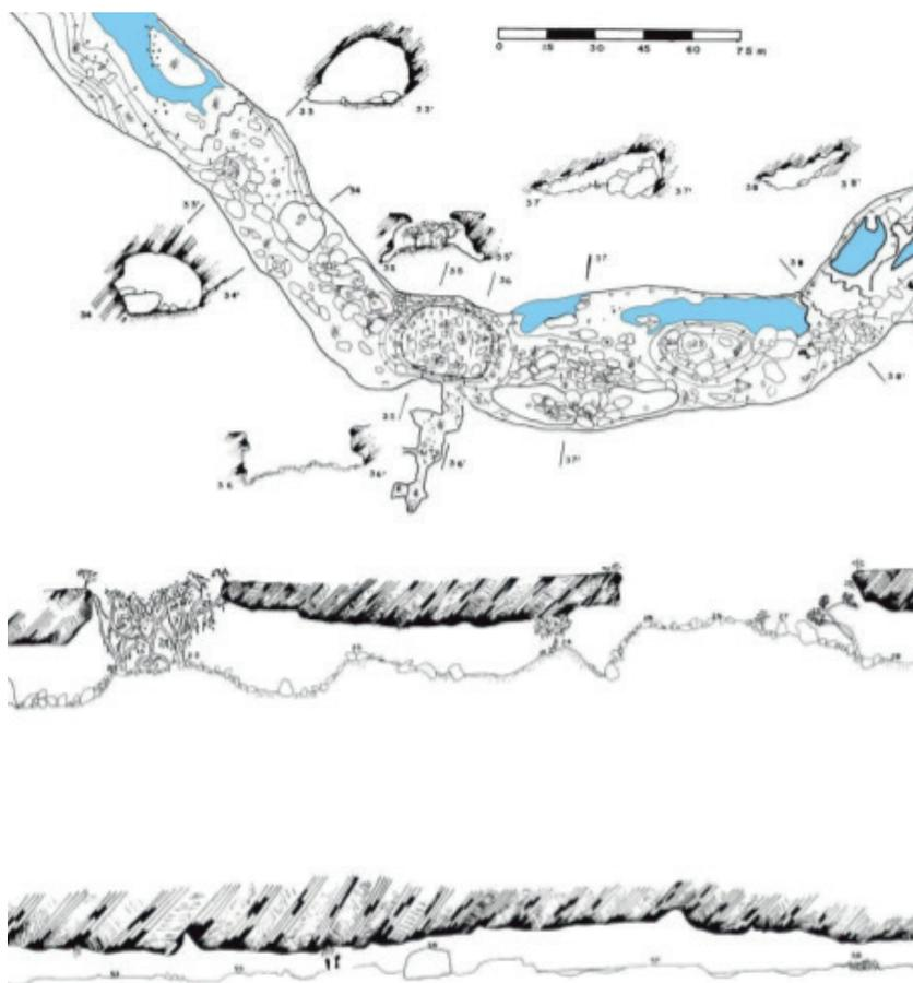
**Figura 5:** Detalhes da Planta Baixa e de Perfis Retificados da Gruta Convento, posteriormente digitalizada.
