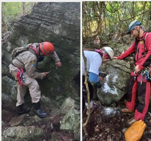
Atividades de fixação de spits com batedores (à esquerda) e parabolts com furadeira (à direita).
