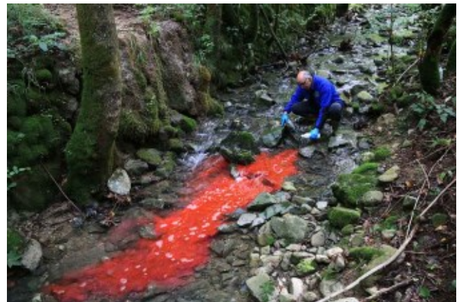
Immissione di solfordamina B.
