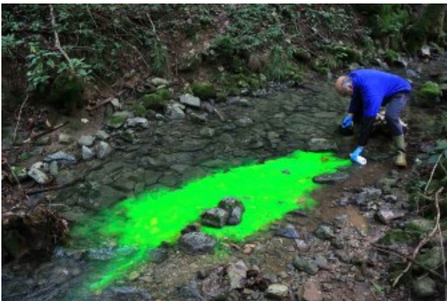
Immissione di fluoresceina nel rio Lieskovaz.
