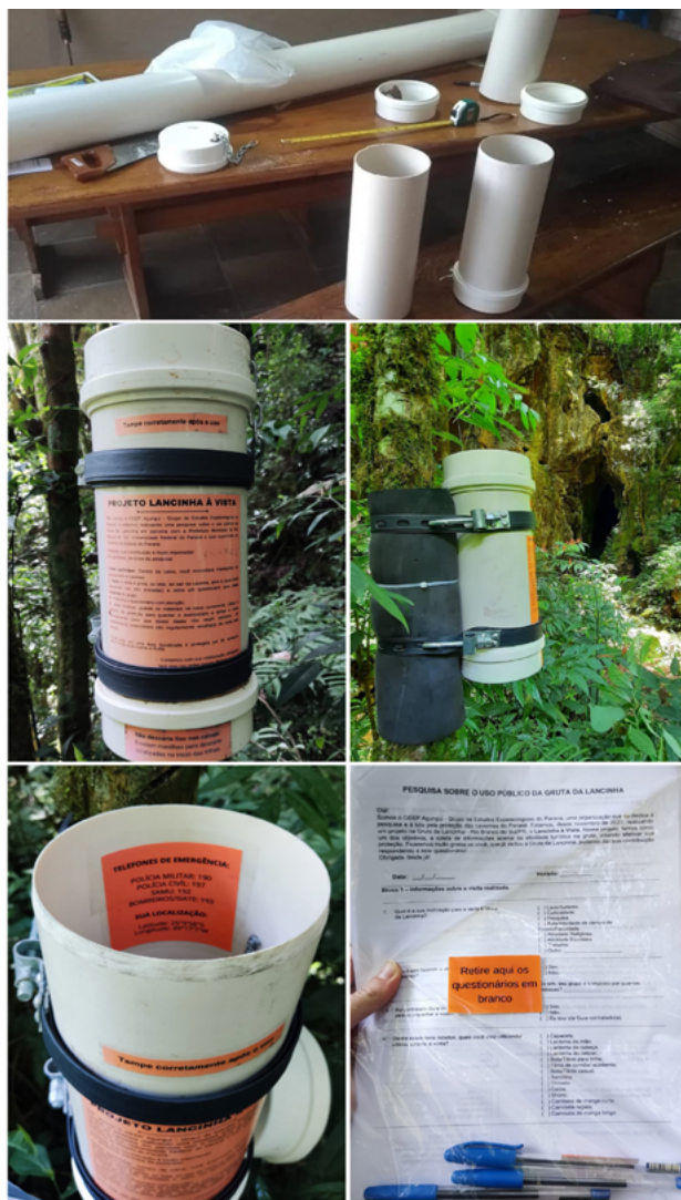
Figura 2: Processo de montagem das caixas, exemplo da instalação e do material interno.
